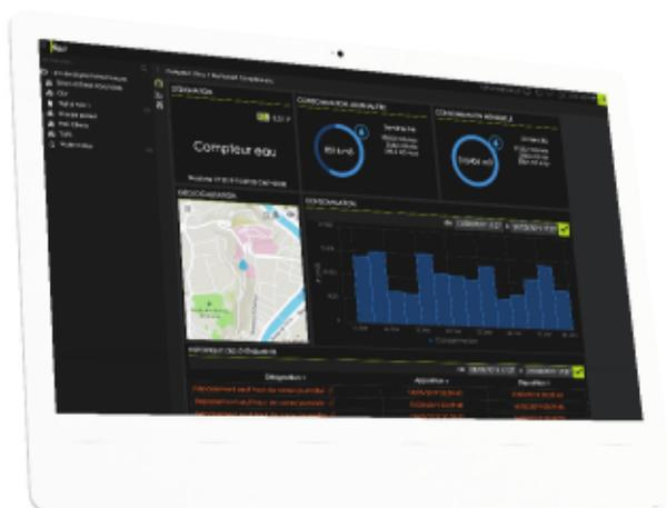
Les plate-formes IoT peuvent être personnalisées pour exploiter les données en provenance de multiples capteurs qui mesurent les consommations d'eau, de gaz, d'électricité.. Sur l'écran de gauche est visualisée la consommation d'eau dans une ville. La carte affiche l'emplacement des différents capteurs.
