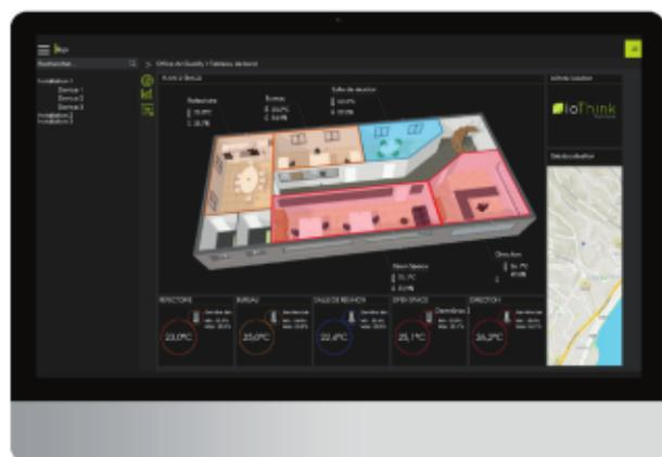
A l'échelle d'un bâtiment une plate-forme IoT permet de visualiser sur un plan les données des capteurs par étage, par pièce ou par chambre. La surveillance à distance permet d'améliorer le confort des usagés et de réduire les dépenses en contrôlant la consommation énergétique.
